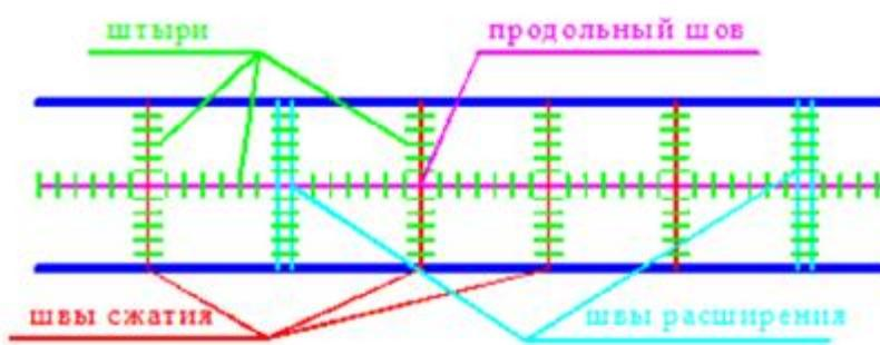
Рисунок 1.2. Схема швов в цементобетонных покрытиях
