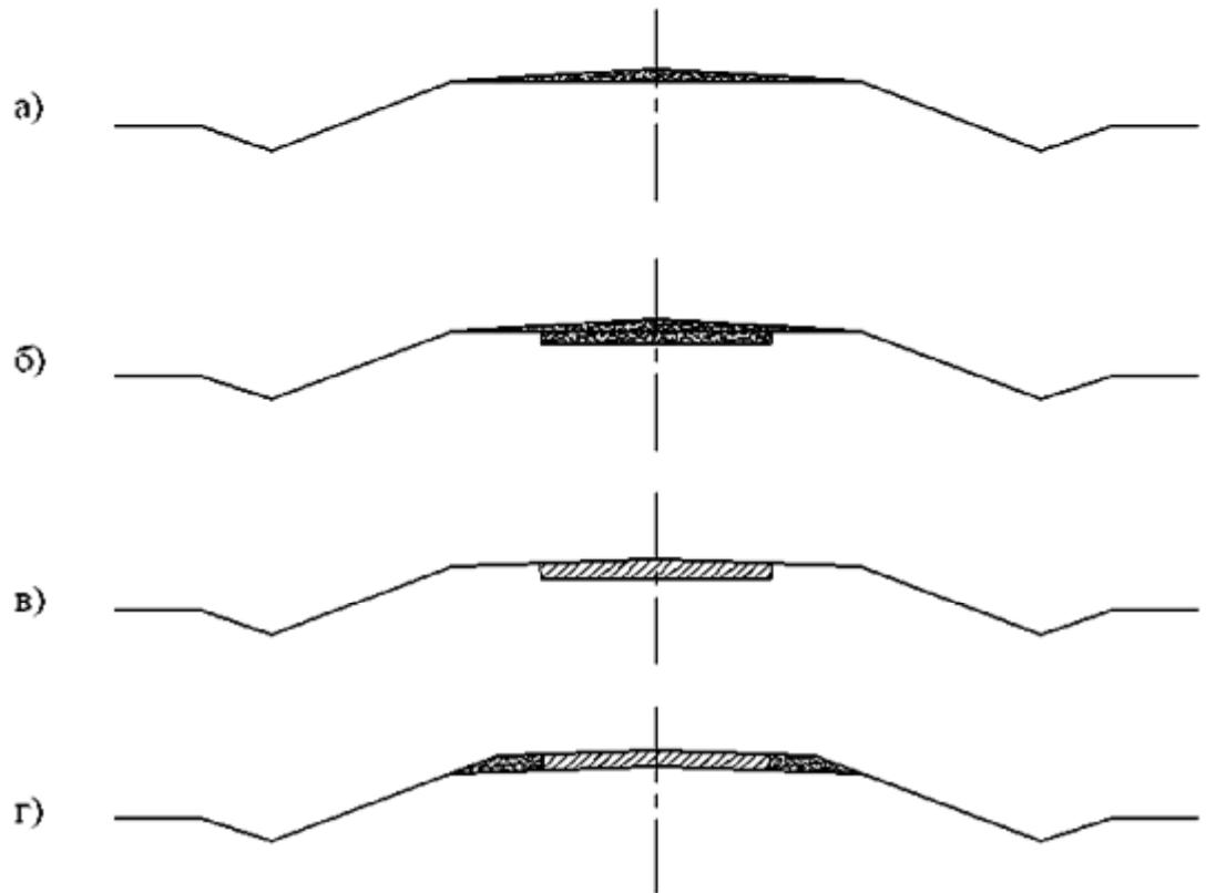
Рисунок 1.3. Поперечные профили дорожной одежды:
